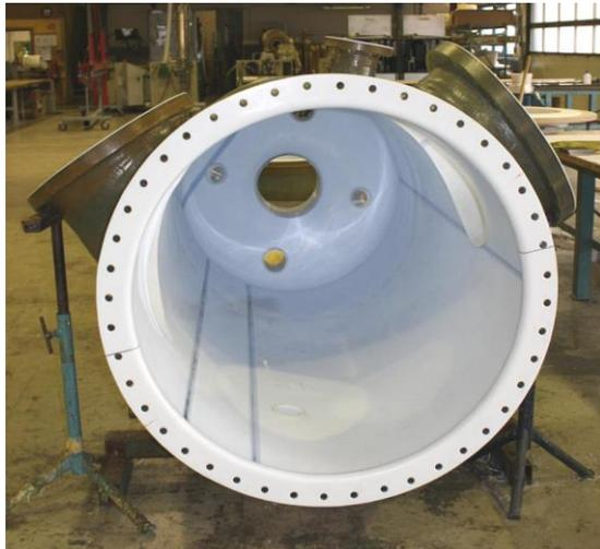
Fluorpolymerauskleidungen von GFK-Systemen, um die hohe Reinheit der für die Chipherstellung verwendeten Chemikalien während der Produktion, der Lagerung, des Transports und der Verwendung sicherzustellen.
