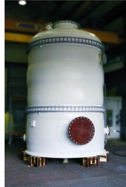
Der Ausschluss jeglicher Metallionen, die das Silizium-Halbleitermaterial verunreinigen würden, lässt sich am besten durch die Verwendung metallfreier GFK-Basismaterialien mit Fluorpolymerauskleidung erreichen.
